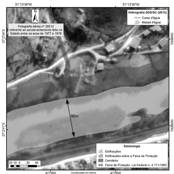
Imagem 1: Exemplo de Cartograma, elaborado utilizando o Sistema de Projeção UTM - Fuso 22J,- Datum SIRGAS2000. A fotografia aérea de 1978 foi ajustada por meio da identificação de pontos homólogos com a Base Cartográfica da SDS (2013). Destacam-se a hidrografia e as respectivas faixas de proteção vigentes à época do aerolevantamento, sobre a qual percebem-se algumas edificações isoladas.
